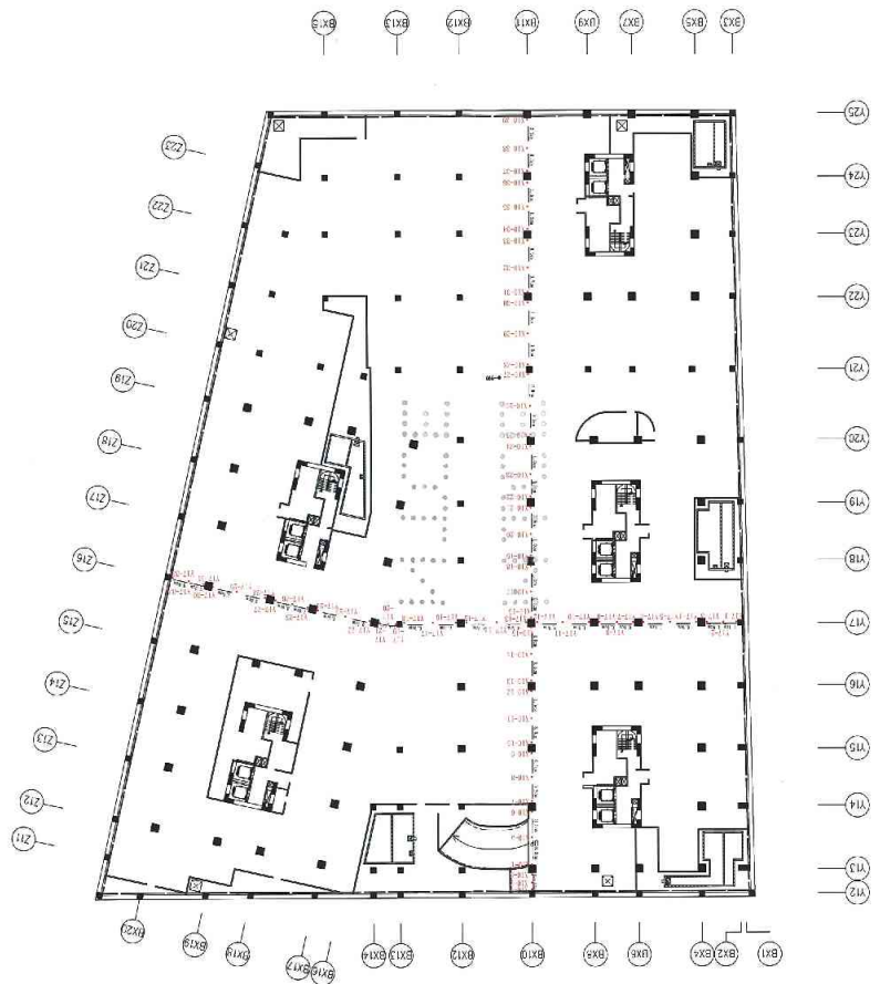
板橋浮洲合宜住宅結構安全鑑定-柱角傾斜及樑底、地坪水平測量工作 A3-2區地下三層-室內地坪水平點分佈位置及比較差值成果示意圖
