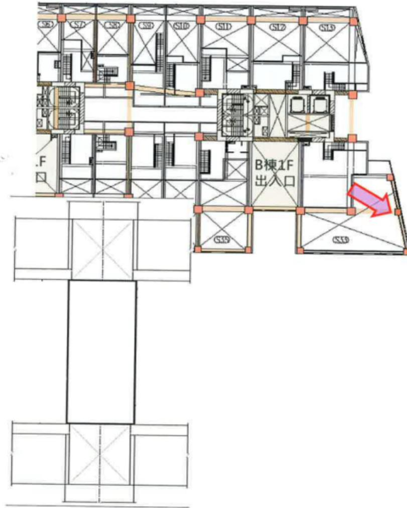
工序：柱保護層打除→牆鑽孔→鋼筋焊接→面材復原
